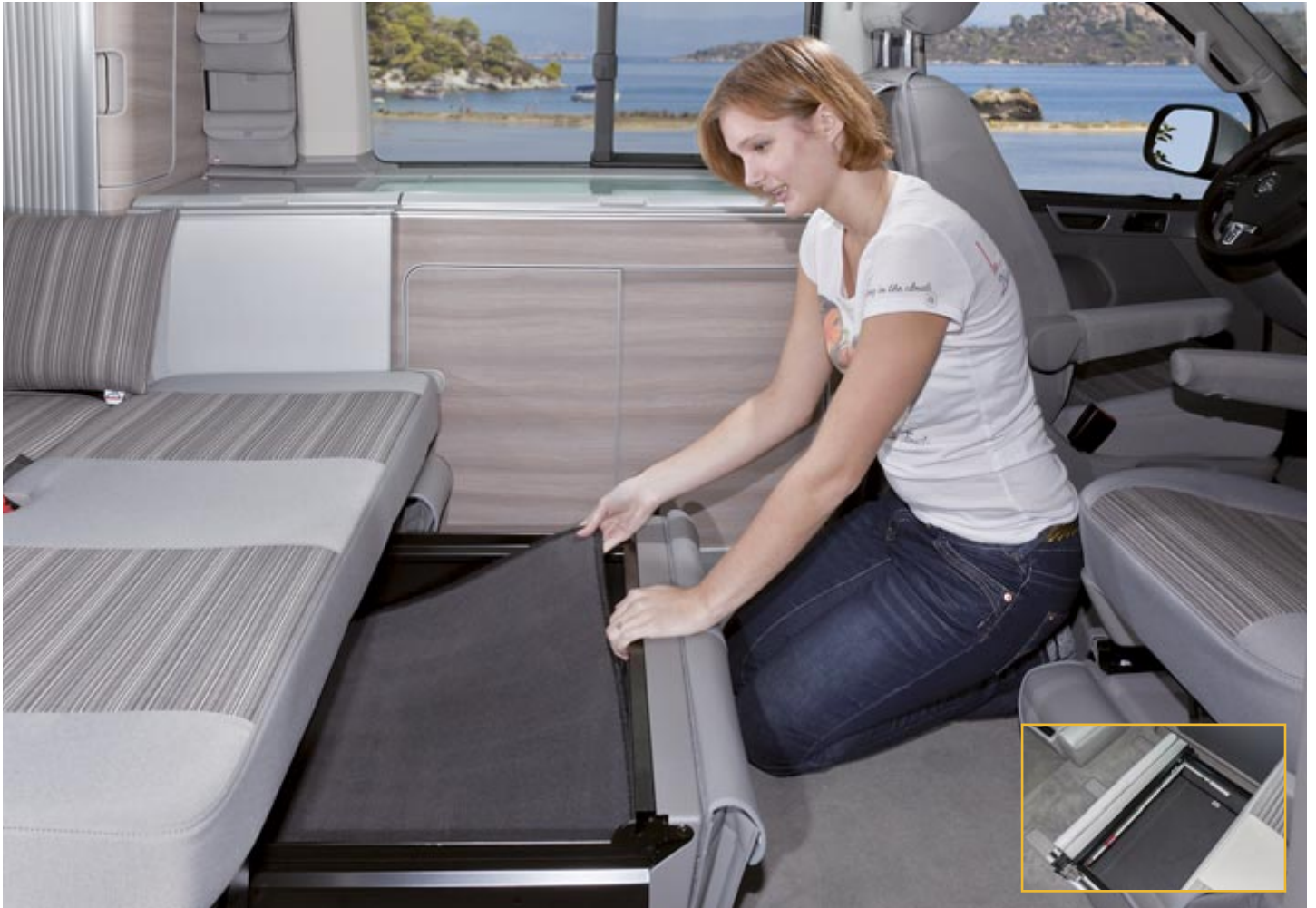
Geräuschkämm-Matte und -Set California T6.1/T6/T5: Sind ideal zur „Beruhigung“ der Blechschublade unter dem Bett (2er-Sitzbank): Abgelegte Sachen „klappern“ nicht mehr und sind besser geschützt. Die Markisenkurbel kann weiterhin eingeklipst werden. Die Geräuschkämm-Matte (Boden) wird in die Schublade eingelegt. Das Geräuschkämm-Set (Seitenteile) hat oben Klettverschluss.
